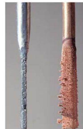
Zn anoda Cu katoda
