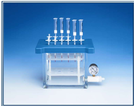
Slika 2. Aparatura za ekstrakciju na čvrstoj fazi.
